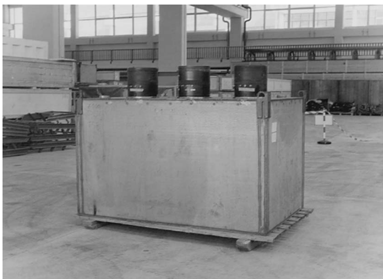
Рис. 1. Сцинтиляционный счетчик объемом 1.5 м 3 .
